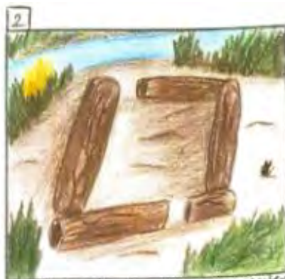
2 Mise en place des rondins pour murs extérieurs.
