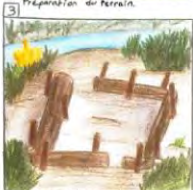
3 Pose des piquets pour maintien des murs.
