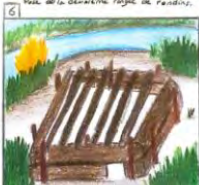
4 Pose de la deuxième rangée de rondins.
